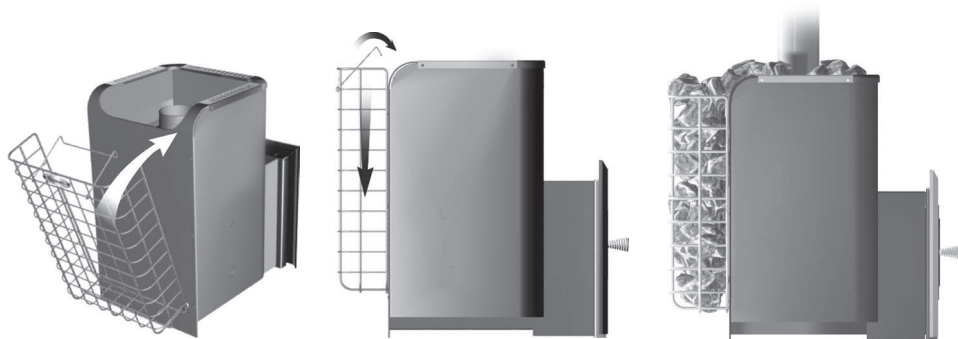
Рисунок- 10. Установка сетки-каменки на печь.
