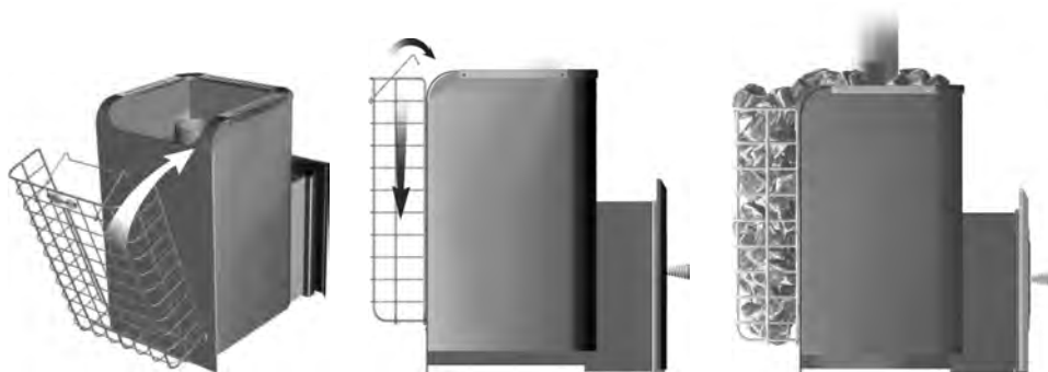
Рисунок -8. Установка сетки-каменки на печь.
