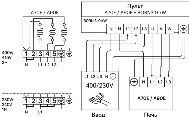
Если соединительный или монтажный кабель подходит к сауне, или сквозь стены сауны, на высоте более 500 мм, они должны выдерживать при полной нагрузке температуру 170 °С. Приборы, устанавливаемые на высоте более 500 мм от уровня пола сауны, должны быть пригодными для использования при температуре 125 °С (маркировка T125).
