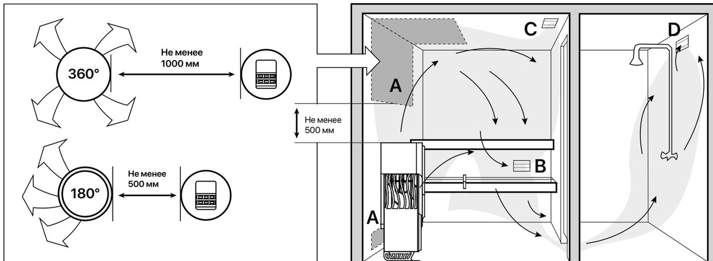
**А.** Размещение приточного вентиляционного отверстия. Если используется механическая вентиляция, поместите вентиляционное отверстие над каменкой. Если вентиляция естественная, поместите вентиляционное отверстие под или рядом с каменкой. Диаметр трубы для притока воздуха должен быть 50-100 мм. **Вентиляционное окно не должно охлаждать температурный датчик (см. инструкции по установке температурного датчика в руководстве по установке пульта управления)!**
