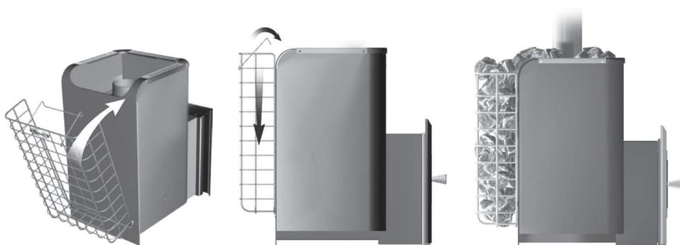
**Рисунок- 10.** Установка сетки-каменки на печь.
