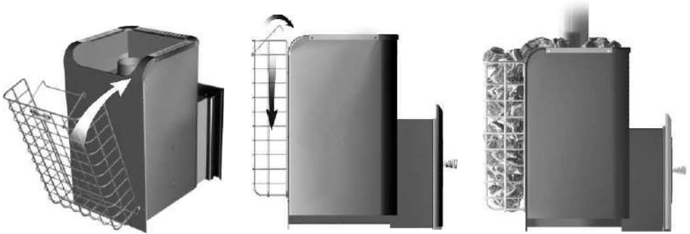
Рисунок - 10. Установка сетки-каменки на печь.
