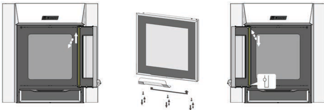
Рисунок - 6. Схема снятия и изменения открытия дверки
