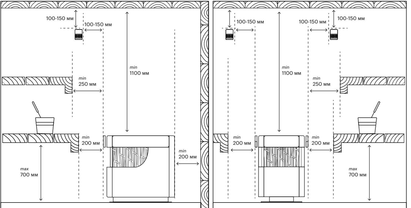
! При установке каменки обязательно соблюдение указанных значений. Несоблюдение указанных значений влечет за собой опасность возгорания. Раскаленные осколки камней могут повредить покрытие пола и вызвать пожар. Покрытие пола в месте установки должно быть несгораемым.
