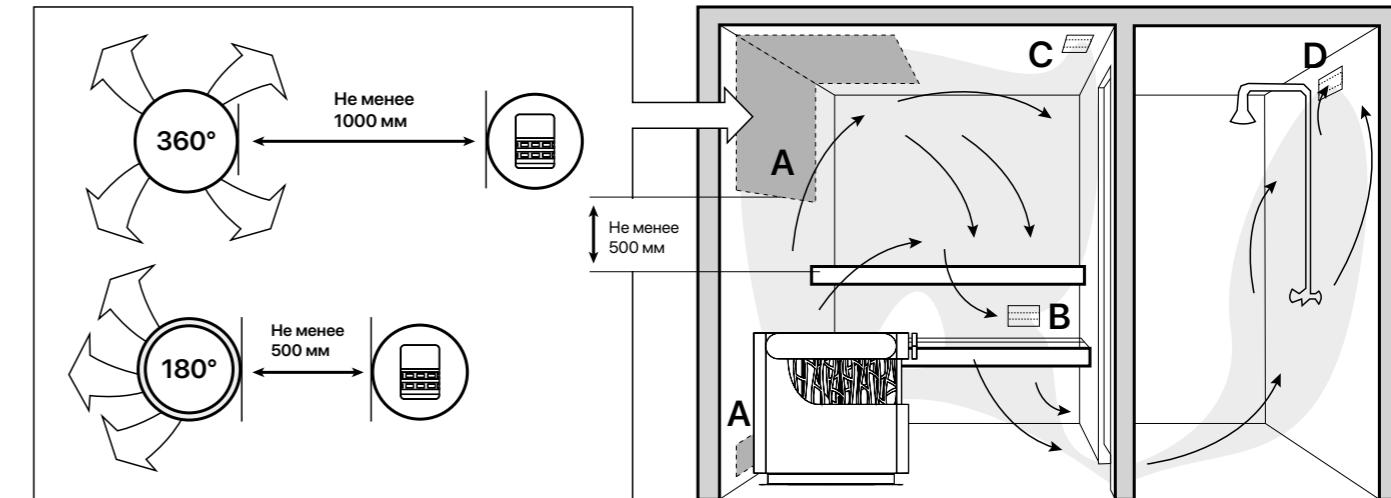
A. Размещение приточного вентиляционного отверстия. Если используется механическая вентиляция, поместите вентиляционное отверстие над каменкой. Если вентиляция естественная, поместите вентиляционное отверстие под или рядом с каменкой. Диаметр трубы для притока воздуха должен быть 50-100 мм. **Вентиляционное окно не должно охлаждать температурный датчик (см. инструкции по установке температурного датчика в руководстве по установке пульта управления)!**
